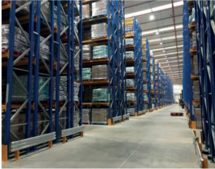
Figura 16: Rack selectivo de doble profundidad
